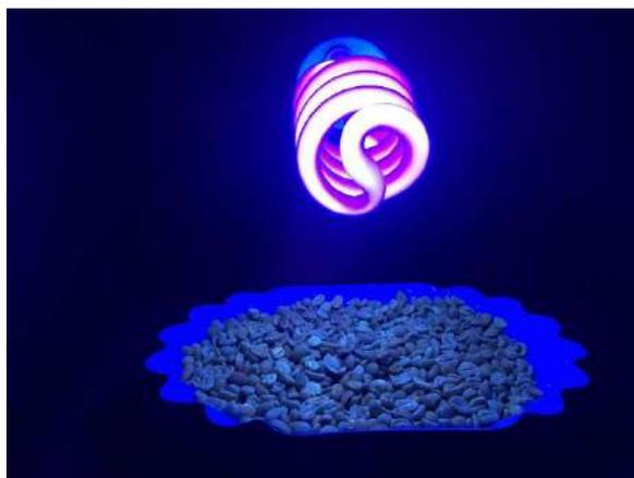
**Figura 32 Utilización de radiación UV para el control de calidad de café en el tostado**
