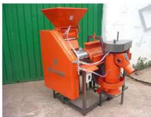
Figura 18 Maquinaria que integra los procesos de despulpado, y lavado final, eliminando el proceso de fermentación, con la finalidad de reducir la huella hídrica a 87.5-95%.
