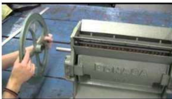
Figura 24 Desensamblaje de despulpadoras de café para el mantenimiento, cambio de piezas, lubricación de engranajes.
