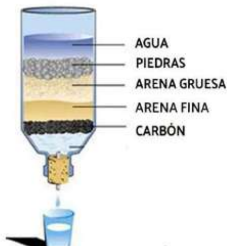
Figura 22 Forma en que se construye un filtro de rocas, arena gruesa, arena fina y carbón activado para capturar insecticidas utilizadas en el tratamiento de frutos con infestación parcial de broca.
