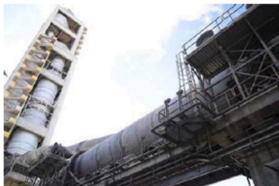
**Figura 57 Hornos cementeros, en donde se alcanzan temperaturas que permiten la incineración y destrucción del plástico y las trazas que pueden haber quedado del triple lavado.**
